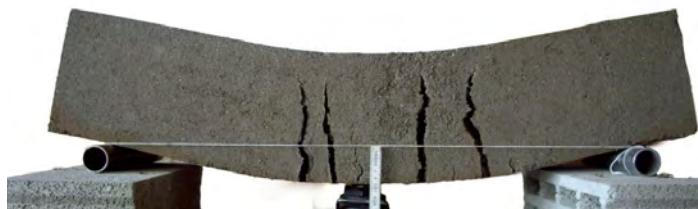
Ohne das Polymeradditiv bleibt das Material brüchiger und es entstehen lange Risse.
